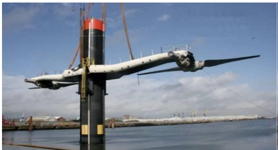
Fig 6 : Le projet SeaGen, prototype de MTC de 1.2 MW
