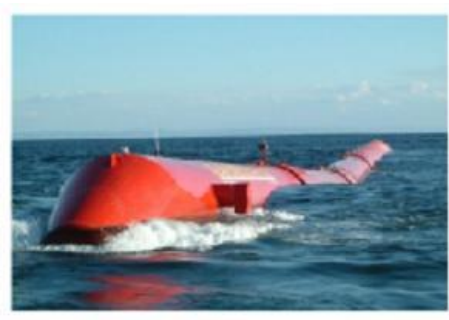
Fig 2 : Le système Pelamis testé au Portugal
