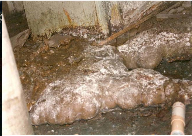
Coulée de combustible en « patte d'éléphant »
