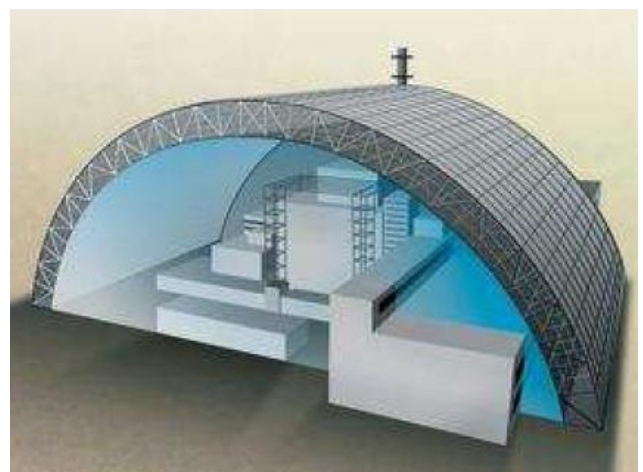
Projet d'« arche » recouvrant le sarcophage
