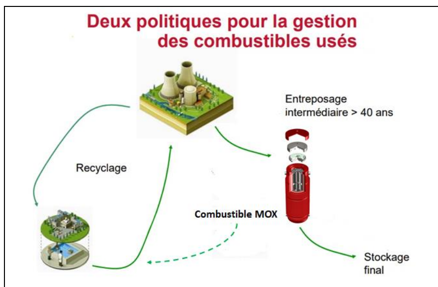
Figure 1 : Principaux modes de gestion du combustible usé
