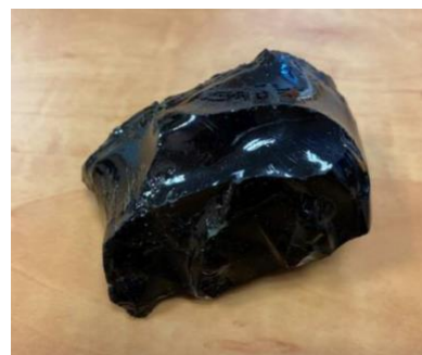
Figure 2 : Echantillon de verre borosilicate contenant les déchets radioactifs
