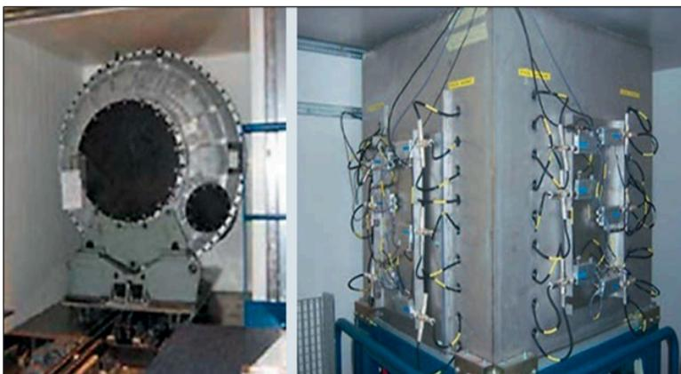
Figure 11 : à gauche : poste de comptage neutronique pour le démantèlement de l'Usine de Pierrelatte ; à droite : poste de comptage neutronique des fûts de 100 L pour le démantèlement de l'installation PÉGASE à Cadarache. (réf [8]).
