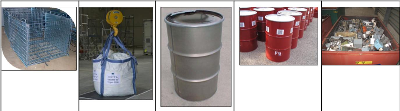
Figure 3 : Exemples d'emballages de pré-conditionnement : panier grillagé, GRVS, fûts, caisson métallique
