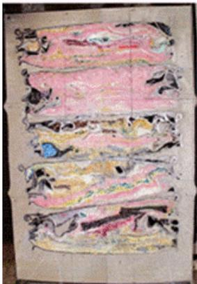
Ces exigences sont par exemple, le compactage, le reconditionnement dans des emballages dont les dimensions sont spécifiées par l'Andra, l'immobilisation par un mortier dans l'emballage définitif (voir figures 4, 5, 6). Les colis prêts à être stockés sont appelés colis de stockage\*.
