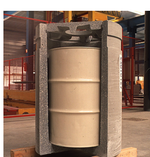
Figure 5 : Exemples de colis de déchets FMA-VC en cours de traitement ou prêts à être expédiés : fût en coque béton fibres cylindrique, déchets vinylés en caisson 5 m 3 standard, 5 fûts en caisson 5 m 3 pré-bétonné, déchets en conteneur béton fibre cubique 5 m 3 .
