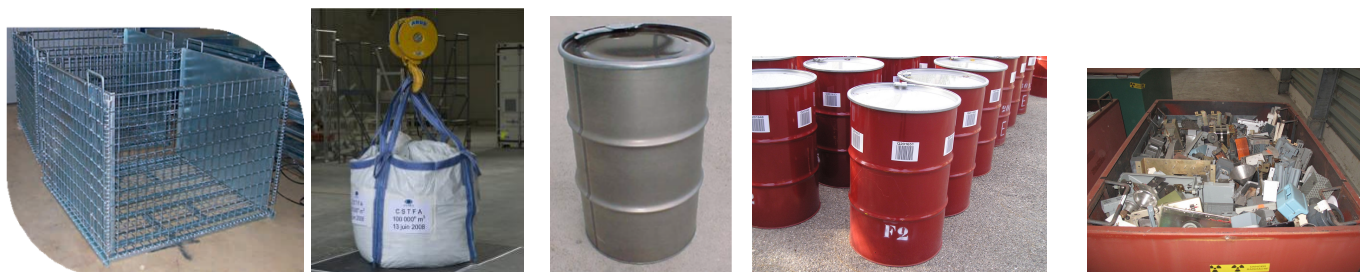
Figure 3 : Exemples d'emballages de préconditionnement : panier grillagé, GRVS, fûts, caisson métallique
