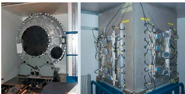
Figure 10 : à gauche : poste de comptage neutronique pour le démantèlement de l'usine de Pierrelatte ; à droite : poste de comptage neutronique des fûts de 100 l pour le démantèlement de l'installation PÉGASE à Cadarache (réf [8]).
