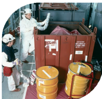
Figure 5 : Exemples de colis de déchets FMA-VC en cours de traitement ou prêts à être expédiés : fût en coque béton fibres cylindrique, déchets vinylés en caisson 5 m 3 standard, 5 fûts en caisson 5 m 3 pré-bétonné, déchets en conteneur béton fibre cubique 5 m 3 .
