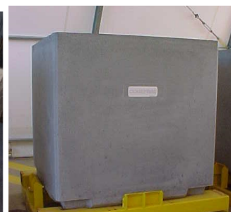
Figure 5 : Exemples de colis de déchets FMA-VC en cours de traitement ou prêts à être expédiés : fût en coque béton fibres cylindrique, déchets vinylés en caisson 5 m 3 standard, 5 fûts en caisson 5 m 3 pré-bétonné, déchets en conteneur béton fibre cubique 5 m 3 .
