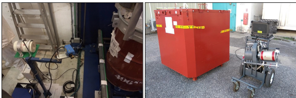
Figure 6 : Exemples de mesure d'activité sur colis
