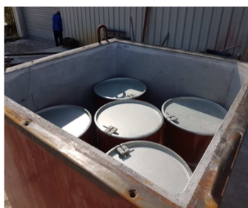
Figure 5 : Exemples de colis de déchets FMA-VC en cours de traitement ou prêts à être expédiés : fût en coque béton fibres cylindrique, déchets vinylés en caisson 5 m 3 standard, 5 fûts en caisson 5 m 3 pré-bétonné, déchets en conteneur béton fibre cubique 5 m 3 .
