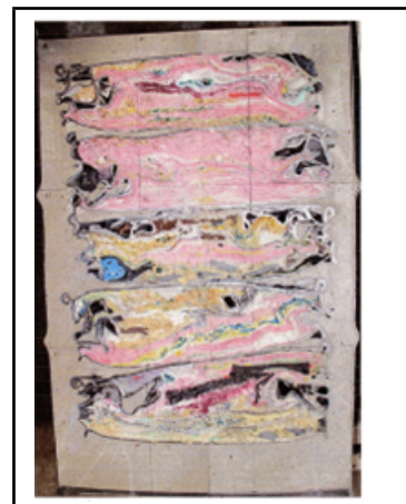
Figure 4 : Maquette découpée de fûts de déchets compactés et immobilisés par du mortier ►
