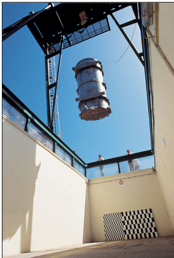
Figure 3 : Essai de chute d'un colis de transport d'une hauteur de 9 m avec un angle de 30°.
