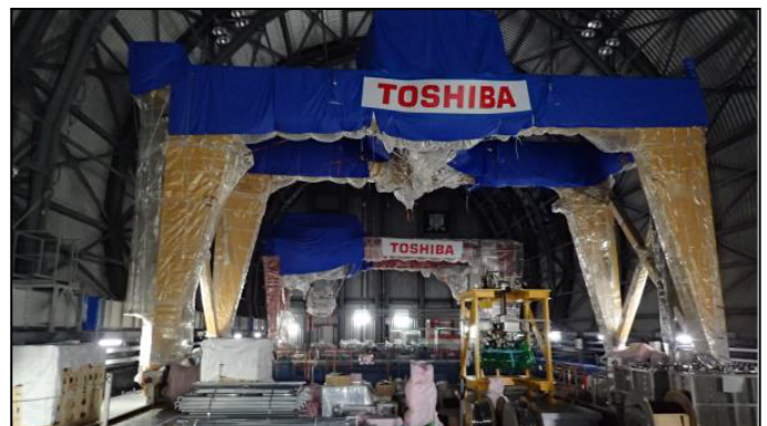
Figure 1 : Vue de la structure recouvrant le bâtiment du réacteur n°3 et des moyens de manutention du combustible qui y sont implantés – Source TEPCO.
