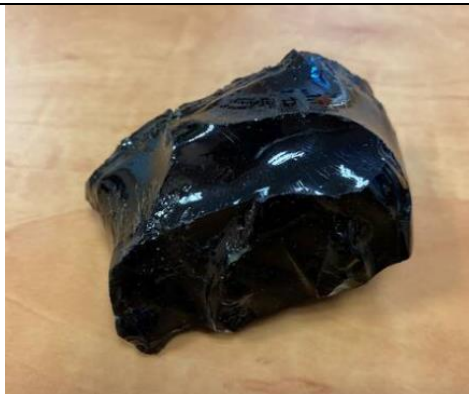
Figure 3 : Verre borosilicate contenant les déchets radioactifs
