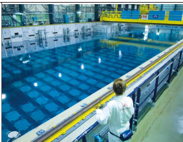
Figure 2 : Piscine de désactivation du combustible irradié à l'usine de retraitement de La Hague
