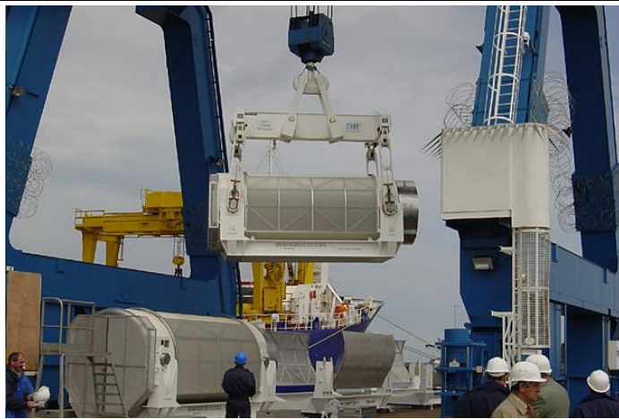
Emballage de transport de résidus vitrifiés de type B(M) en cours de chargement sur un bateau spécialisé.
