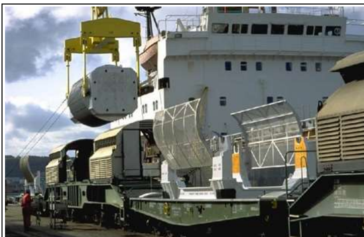
Emballage de transport de combustible usé REP en cours de chargement sur le Sygin
