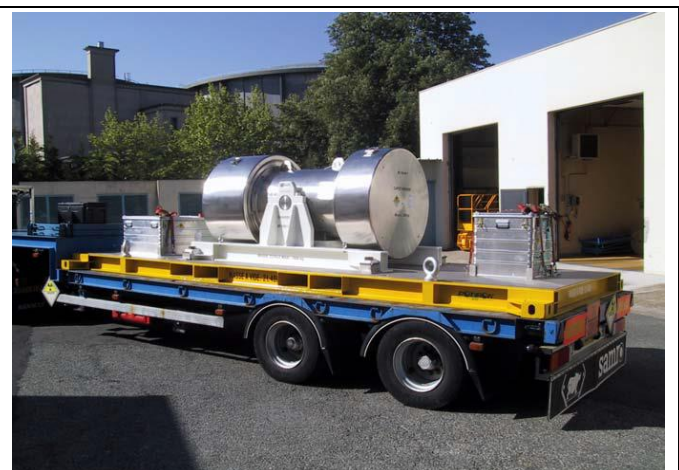
Emballage de transport de crayons combustibles irradiés à des fins de R&amp;D (Type B)
