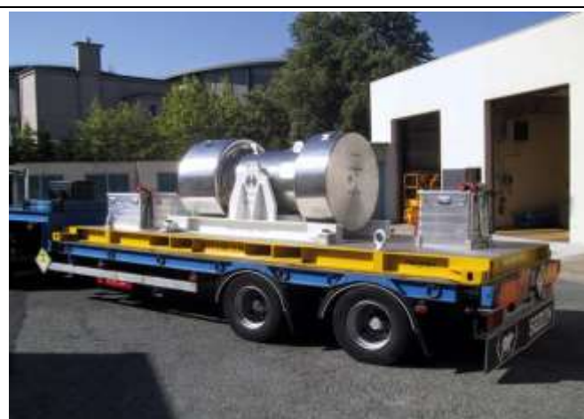
Emballage de transport de crayons combustibles irradiés à des fins de R&D (Type B)
