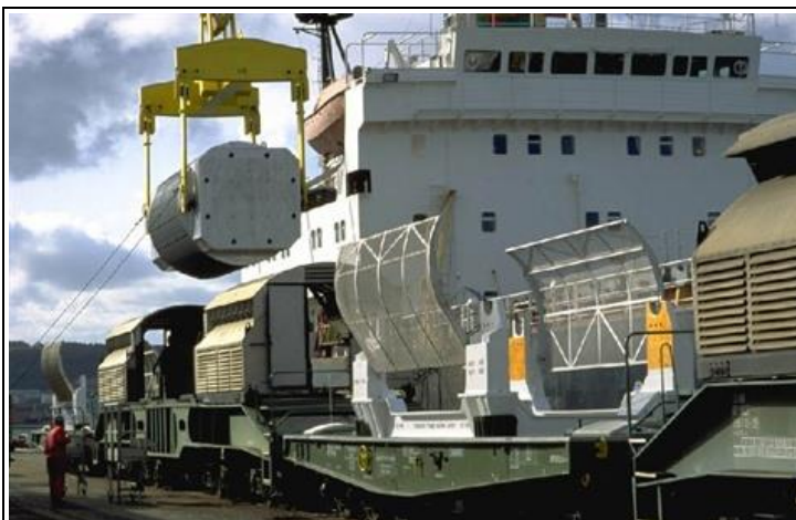
Emballage de transport de combustible usé REP en cours de chargement sur le Sygn
