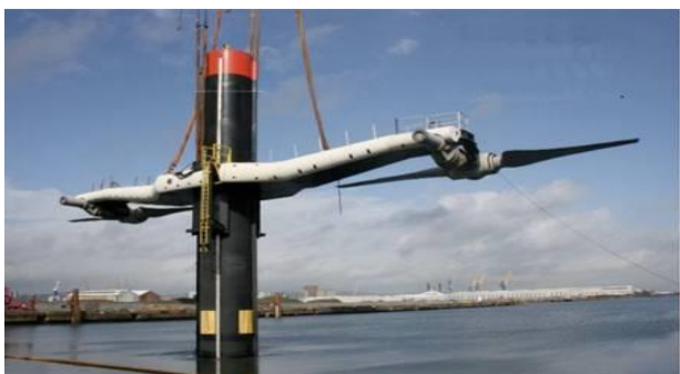
Fig 5 : Le projet SeaGen, prototype de MTC de 1.2 MW
