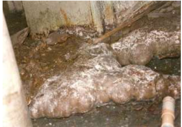
Coulée de combustible en « patte d'éléphant »
