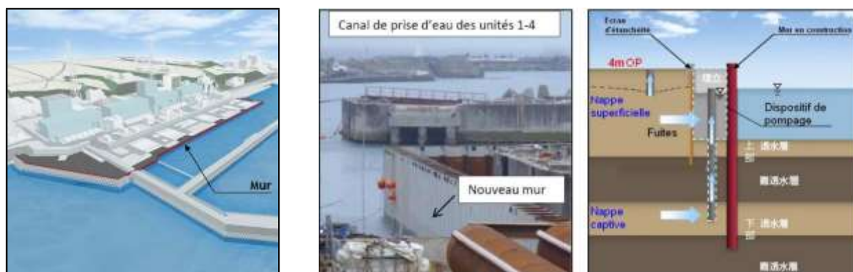
Fig. 3 – Mur d'étanchéité en construction [2d]
