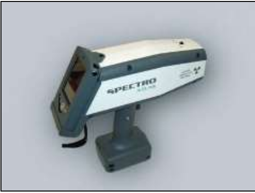
Appareil portable d'analyse par fluorescence X © Source AIEA
