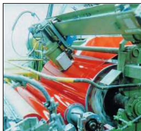
Mesure de grammage par rétrodiffusion © Source UARGA
