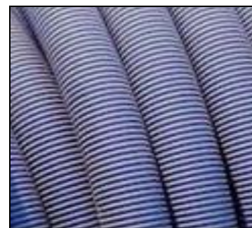
Polymérisation de gaines rétractables © Source Ionisos
