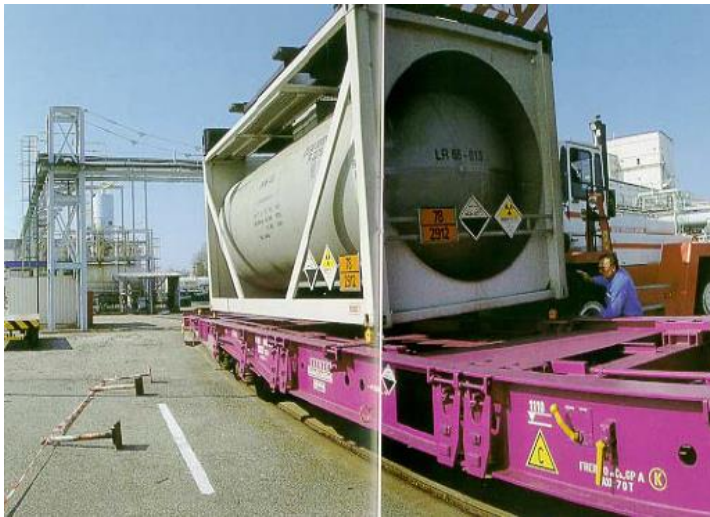
Emballage de transport de nitrate d'uranyle (type IP-2)
