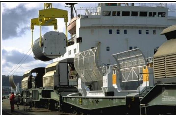
Emballage de transport de combustible usé REP en cours de chargement sur le Sygin
