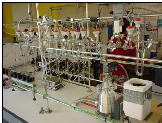
Banc de préparation automatique pour les échantillons datés au carbone 14
