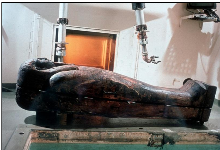
Figure 1 : Irradiation d'une momie du musée des beaux-arts de Grenoble en préalable de l'irradiation de la momie de Ramsès II
